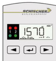
Betrieb ↔ Parametrierung, für 3 s drücken.
