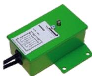
Zur End- oder Zwischenstellungssignalisation können externe, einstellbare Hilfsschalter Typ InSwitch nachgerüstet werden. Das Hilfsschaltergehäuse wird direkt in den abtriebsseitigen Doppelvierkant gesteckt und mit dem Antrieb verschraubt. Die beiden Hilfsschalter haben je einen potenzialfreien Umschaltkontakt und sind unabhängig voneinander justierbar. Der Anschluss erfolgt über Kabel.
