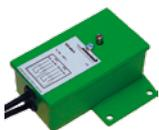
Zur End- oder Zwischenstellungssignalisation können externe, einstellbare Hilfsschalter Type InSwitch nachgerüstet werden. Das Hilfsschaltergehäuse wird direkt in den Deckel gesteckt und mit dem Antrieb verschraubt. Die beiden Hilfsschalter haben je einen potenzialfreien Umschaltkontakt und sind unabhängig voneinander justierbar. Der Anschluss erfolgt über Kabelschwanz (siehe ..Switch Datenblatt).
