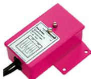
Zur End- oder Zwischenstellungssignalisation können externe, einstellbare, explosionsgeschützte Hilfsschalter Typ RedSwitch nachgerüstet werden. Der ...Switch wird direkt an den Antrieb montiert. Die beiden Hilfsschalter haben je einen potenzialfreien Umschaltkontakt und sind unabhängig voneinander justierbar. Der Anschluss erfolgt über Kabel.
