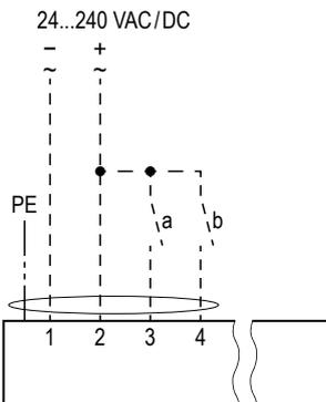
Integrierte Hilfsschalter, netzseitige Sicherung empfohlen.
