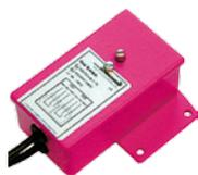
Zur End- oder Zwischenstellungssignalisation können externe, einstellbare, explosionsgeschützte Hilfsschalter Typ RedSwitch nachgerüstet werden. Der ...Switch wird direkt an den Antrieb montiert. Die beiden Hilfsschalter haben je einen potenzialfreien Umschaltkontakt und sind unabhängig voneinander justierbar. Der Anschluss erfolgt über Kabel.
