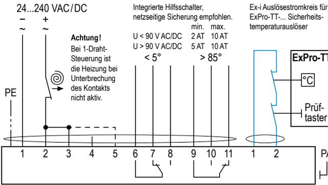
Federrücklauf in ~ 10 s = Standard-Anschluss
