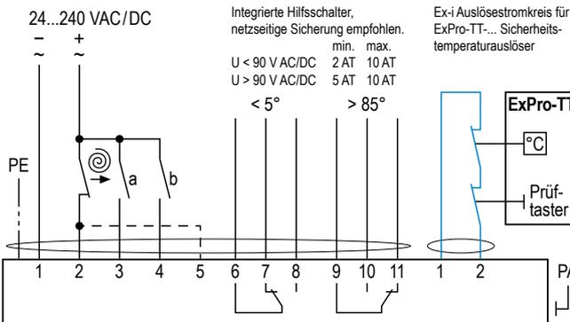
Federrücklauf in ~ 10 s = Standard-Anschluss
